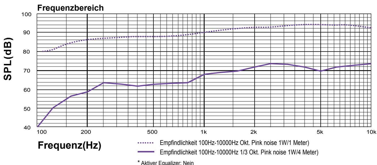
Der MCS40T/EN wurde für 100 h bei voller Leistung (40W) getestet. Die Serie weicht nicht um mehr als 3dB vom ursprünglichen Ergebnis ab. Frequenzgang und Impedanz entsprechen dem ursprünglichen Wert. Frequenzgang und Impedanz blieben über den Messzeitraum konstant. Alle Resultate entsprechen den Forderungen der EN54-24.
